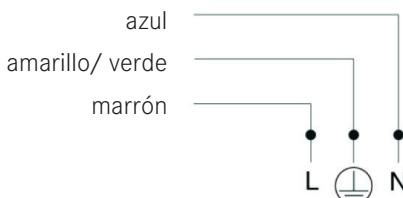
► Asegúrese de que las características del sistema eléctrico doméstico (voltaje, potencia máxima y corriente) son compatibles con las del horno.
