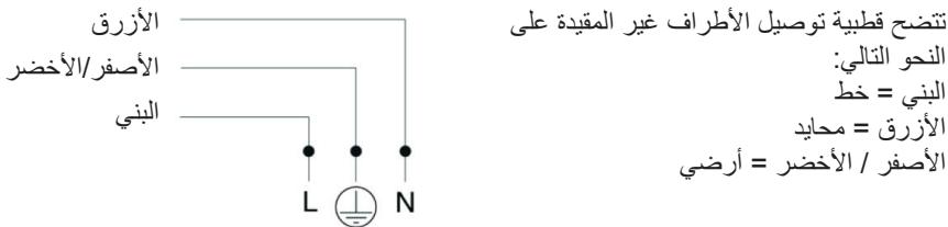
تأكد من توافق خصائص النظام الكهربائي المنزلي مثل (الجهد الكهربائي والطاقة القصوى والتيار الكهربى) مع خصائص الفرن.
