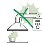
Підключайте витяжку до димоходу за допомогою труби діаметром щонайменше 120 мм. Шлях до димоходу повинен бути якомога коротшим.
