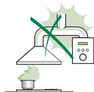
Conectați ventilatorul extractor la conducta de evacuare a fumului cu ajutorul unei conducte cu diametrul minim de 120 mm. Traseul fumului trebuie să fie cât mai scurt posibil.
