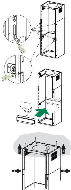
Avant de serrer définitivement les vis, on pourra effectuer des réglages en déplaçant le treillis, en veillant à ce que les vis ne sortent pas du logement de la fente de réglage.
