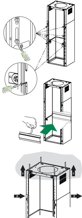
Prima di serrare definitivamente le viti è possibile effettuare delle regolazioni spostando il traliccio facendo attenzione che le viti non escano dalla sede dell'asola di regolazione.
