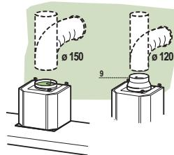
**Achtung!** Alle Querschnittänderungen oder Richtungsänderungen des Abluftkanals reduzieren die Leistung der Haube.
