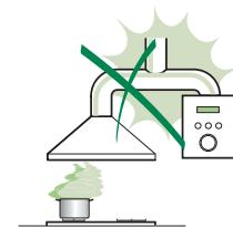
Aspiratörü egzoz bacasına minimum çapı 120 mm olan bir boru vasıtasyla bağlayın. Baca hattı mümkün olduğu kadar kısa olmalıdır.
