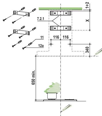
⚠ Achtung: Bitte beachten Sie bei der Montage das Gewicht der kompletten Haube. Die Tragfähigkeit der Decke oder alternativ der Trägerplatte für diese Zugbelastung muss vor der Montage geprüft und gegebenenfalls durch die Anbringung von geeigneten Befestigungs- oder Stabilisierungselementen hergestellt werden. Kann eine hinreichende Tragfähigkeit nicht sichergestellt werden, ist von einer Montage abzusehen.
