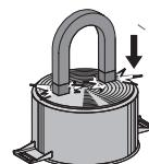
**Obs:** Använd endast köksredskap med en helt platt botten och som är lämpliga för induktionshällens tillagningszoner. Att använda köksredskap med en ojämн botten kan äventyra värmesystemets effektivitet och förhindra att köksredskap detekteras i tillagningszonen.
