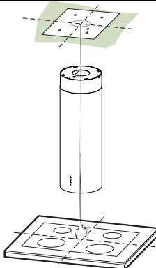
Děrovací schéma strop/konzola a připevnění kostry
