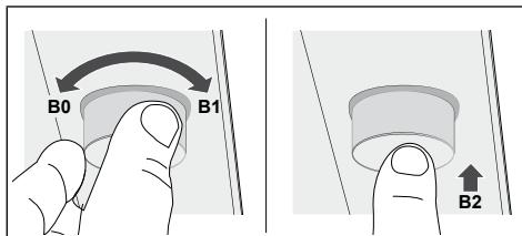
Durch Drehen des Knaufs im Uhrzeigersinn wird die Geschwindigkeit erhöht und wechselt von:
