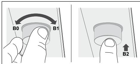
Ruotando la manopola in senso orario, si incrementano le velocità passando da:
