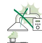
Підключайте витяжку до димоходу за допомогою труби діаметром щонайменше 120 мм. Шлях до димоходу повинен бути якомога коротшим.
