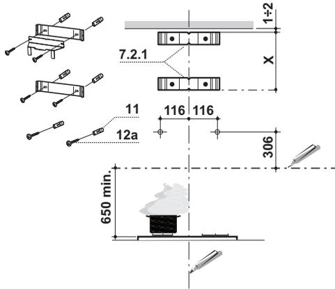
**⚠ Achtung:** Bitte beachten Sie bei der Montage das Gewicht der kompletten Haube. Die Tragfähigkeit der Decke oder alternativ der Trägerplatte für diese Zugbelastung muss vor der Montage geprüft und gegebenenfalls durch die Anbringung von geeigneten Befestigungs- oder Stabilisierungselementen hergestellt werden. Kann eine hinreichende Tragfähigkeit nicht sichergestellt werden, ist von einer Montage abzusehen.
