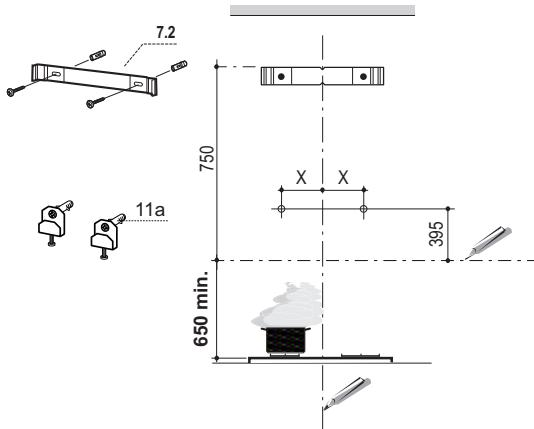
⚠ Achtung: Bitte beachten Sie bei der Montage das Gewicht der kompletten Haube. Die Tragfähigkeit der Decke oder alternativ der Trägerplatte für diese Zugbelastung muss vor der Montage geprüft und gegebenenfalls durch die Anbringung von geeigneten Befestigungs- oder Stabilisierungselementen hergestellt werden. Kann eine hinreichende Tragfähigkeit nicht sichergestellt werden, ist von einer Montage abzusehen.
