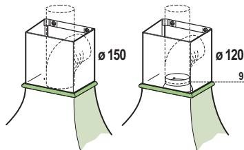
**⚠ Achtung! Alle Querschnittänderungen oder Richtungsänderungen des Abluftkanals reduzieren die Leistung der Haube.**
