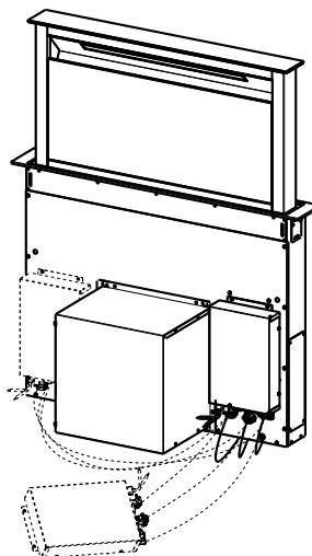
⚠️ **Advarsel:** Lad ikke forbindelseskassen være i kontakt med gulvet, når apparatet installeres.
