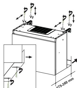
En cas d'installation de la Hotte dans la Version Aspirante, retirer la Grille sur la sortie d'évacuation de l'air.
