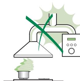
Aspiratörü egzoz bacasına minimum çapı 120 mm olan bir boru vasıtıyla bağlayın. Baca hattı mümkün olduğu kadar kısa olmalıdır.
