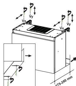
Nel caso di Istallazione della Cappa in Versione Aspirante, rimuovere la Griglia sull'uscita dell'aria.
