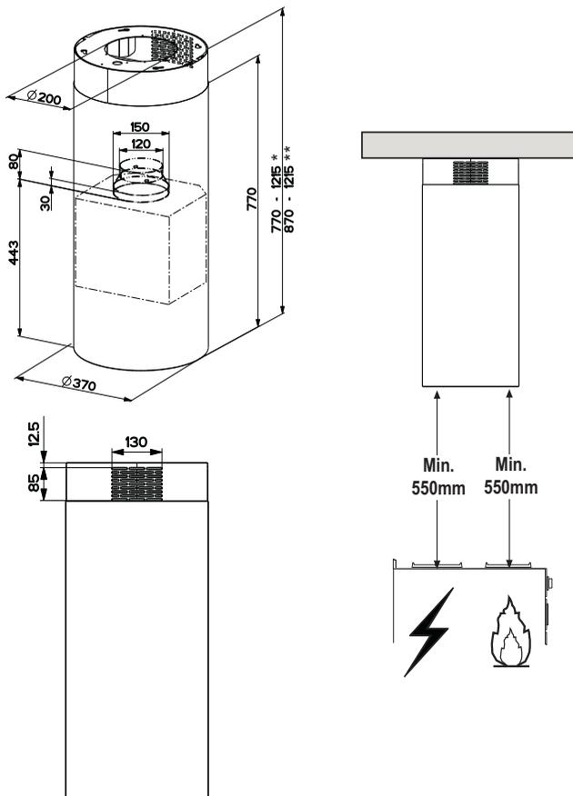
\* Abmessungen der Haube in Abluftversion.
