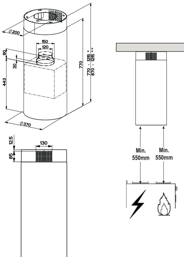
\* Rozměry digestoře v nasávacím provedení.
