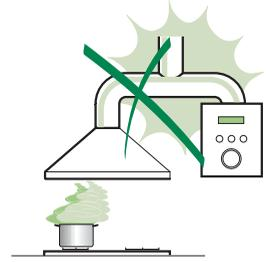
Aspiratörü egzoz bacasına minimum çapı 120 mm olan bir boru vasıtasıyla bağlayın. Baca hattı mümkün olduğu kadar kısa olmalıdır.
