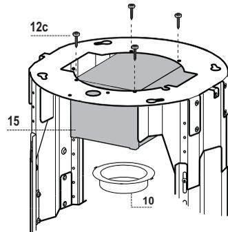
**ATTENZIONE:** Solo per la Versione filtrante rimuovere l'etichetta adesiva dalle asole sul camino superiore!
