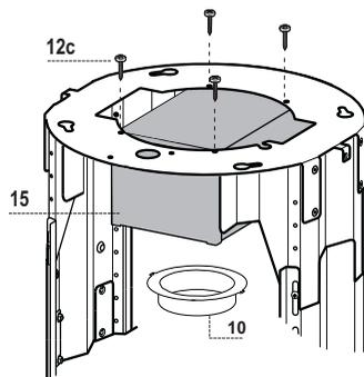
**UPOZORNĚNÍ:** Pouze u filtračního provedení odstraňte samolepící štítek z otvorů na horním komínu!
