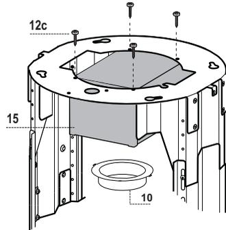
**ACHTUNG: Nur bei der Umluftversion das Klebeetikett von den Ösen am oberen Kaminteil entfernen!**
