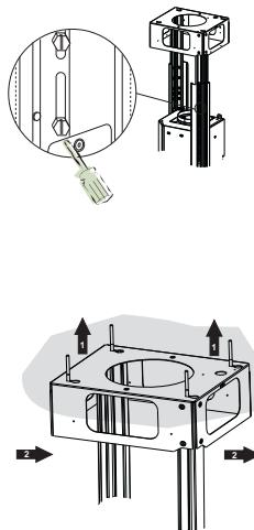
Prima di serrare definitivamente le viti è possibile effettuare delle regolazioni spostando il traliccio, facendo attenzione che le viti non escano dalla sede dell'asola di regolazione.
