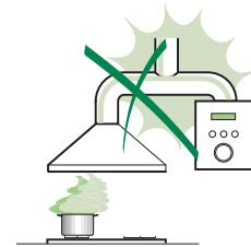
Sluit de afzuiginrichting op het rookkanaal aan met een pijp met een minimale diameter van 120 mm. De rook moet een zo kort mogelijk traject afleggen.
