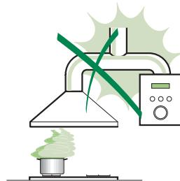
Připojte odsávač k dýmníku pomocí trubice o minimálním průměru 120 mm. Trasa výparů musí být co nejkratší.
