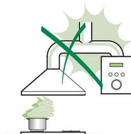
Slut emhætten til røgaftrækket ved hjælp af et rør med en diameter på min. 120 mm. Rørforbindelsens gennemgang skal være så kort som mulig.
